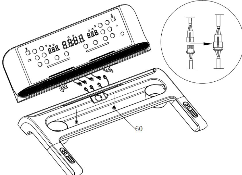
**SCHRITT 2:** Legen Sie den Hauptrahmen auf den Boden. Heben Sie die Frontstützen an und verwenden Sie die mitgelieferten M8\*16-Schrauben (60) und Unterlegscheiben (26), um sie am Hauptrahmen zu befestigen (die Schrauben dürfen nicht fest angezogen werden).
