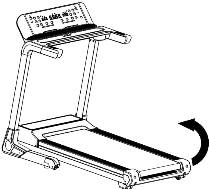
Heben Sie die Lauffläche an und ziehen Sie es mit Kraft nach oben, bis Sie ein "Klicken" hören und Sie spüren, dass der Sicherheitsmechanismus eingerastet ist.
