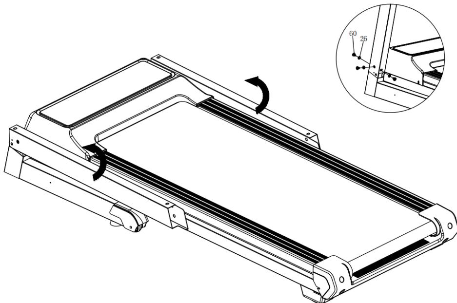
**SCHRITT 3:** Verbinden Sie die Kabel zwischen der Konsole und der rechten Frontstütze (16R) und befestigen Sie die Konsole mit M8\*16-Schrauben (60) und Unterlegscheiben (26) an den Frontstützen (ziehen Sie alle Schrauben fest an).
