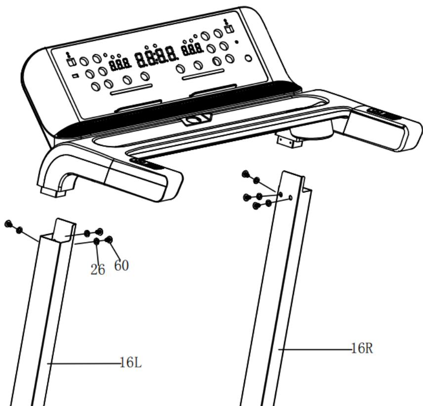
**Fase 4:** Utilizzare le viti M4.2\*16 in dotazione (3) per fissare saldamente il coperchio ai supporti anteriori (16L/R).
