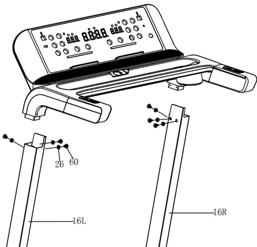
**Schritt 4:** Verwenden Sie die mitgelieferten M4,2\*16-Schrauben (3), um die Abdeckung fest an den Frontstützen (16L/R) zu befestigen.
