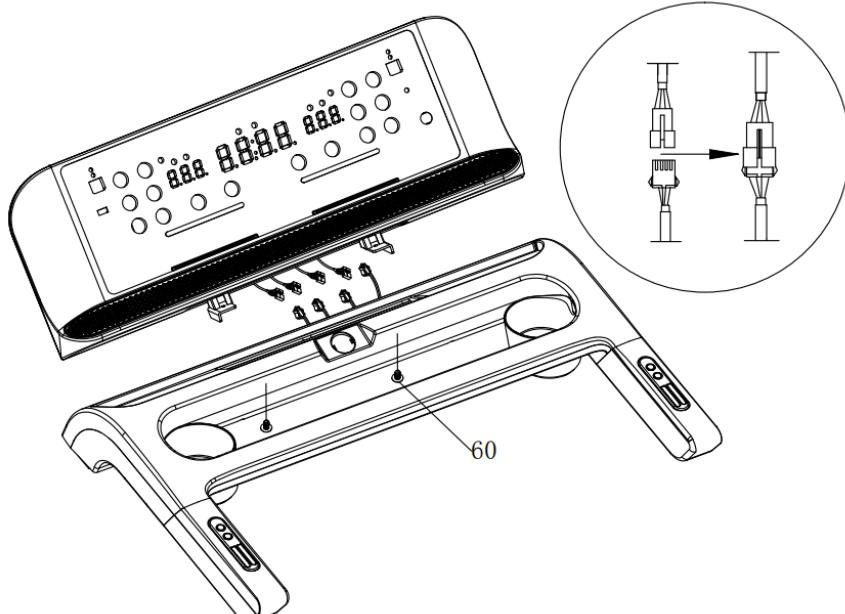
**FASE 2:** Posizionare il telaio principale sul pavimento. Sollevare i supporti anteriori e utilizzare i bulloni M8\*16 (60) e le rondelle (26) in dotazione per fissarli al telaio principale (non serrare i bulloni).
